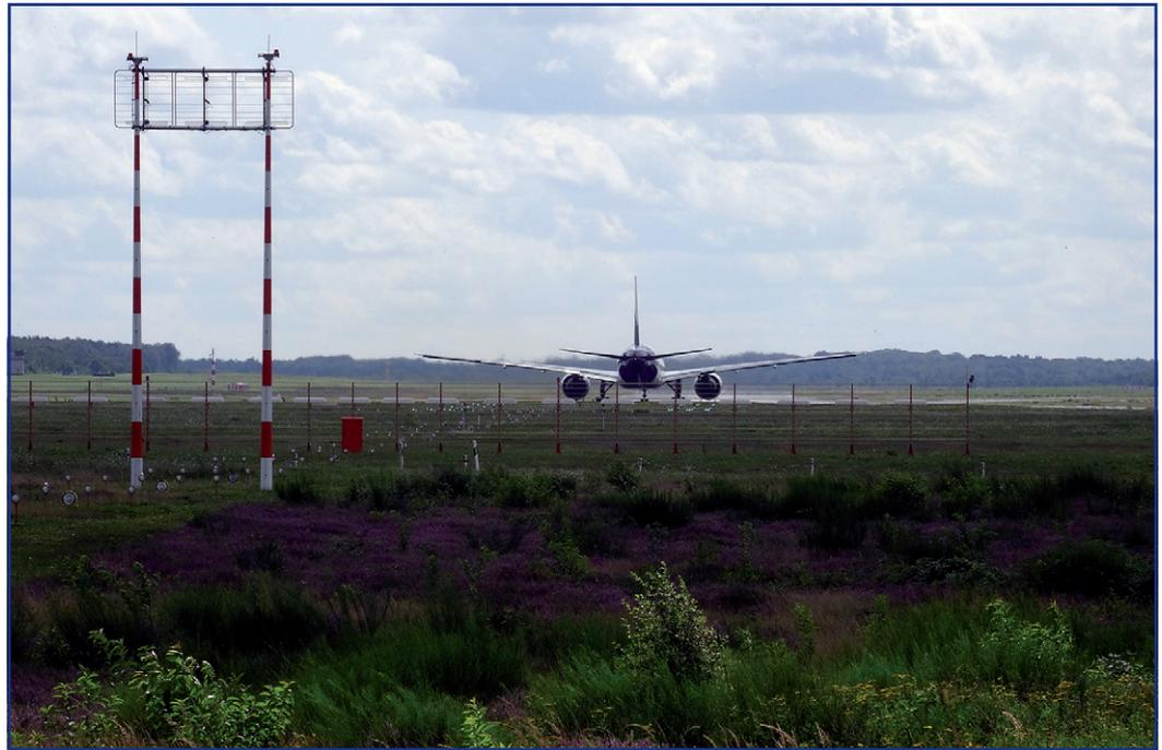
Abbildung 1: Schutzbedürftige Flugsicherungsanlagen (ILS-Landekursender/Kursmonitor) am Flugplatz. Bildquelle: GfL mbH
