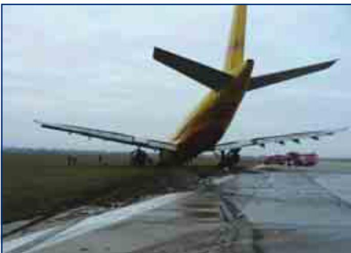
Abbildung 1: Bruch des Bugfahrwerkes nach Veer Off in den Streifen der SLB. Quelle: BEA, 2013
