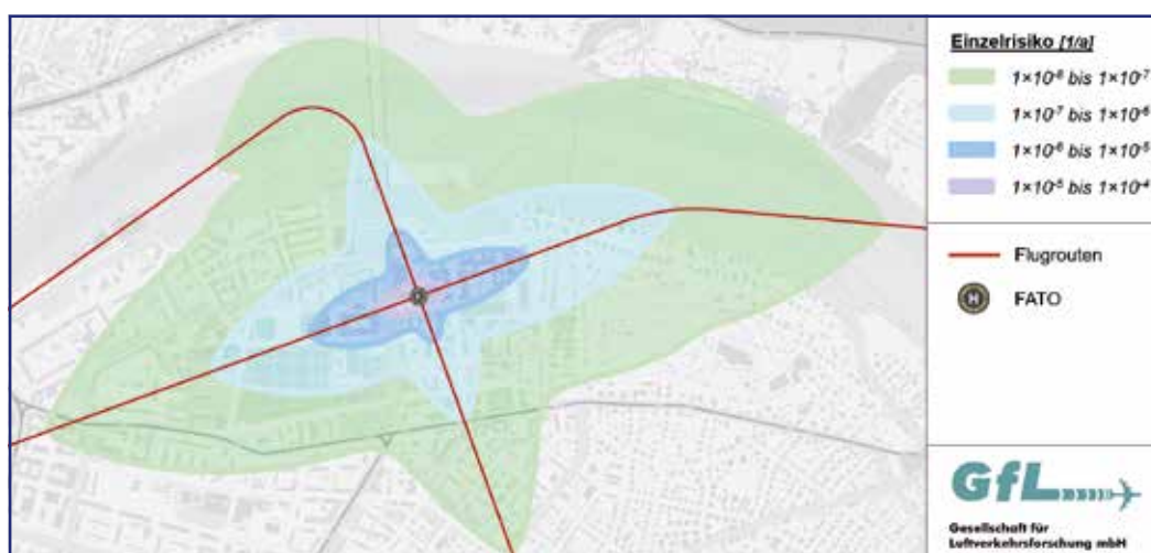
Abb. 3: Ergebnisse des Einzelrisikos für eine fiktive FATO mit vier An- und Abflugrouten. Bildquelle: GfL mbH
